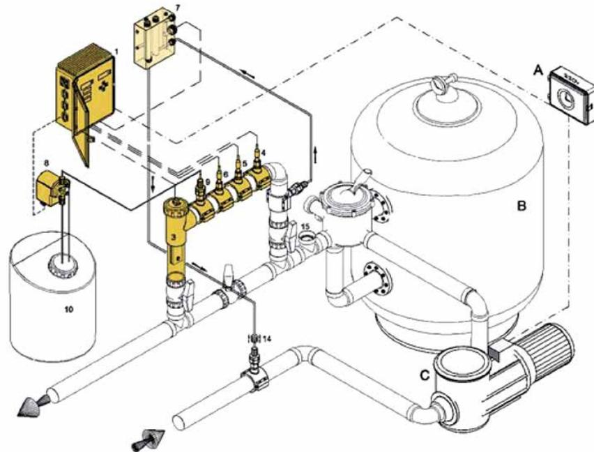
Les systèmes d'électrolyse saline sont un nouveau concept de traitement de l'eau pour les piscines. Ils améliorent la qualité de l'eau, diminuent les risques de manipulation et simplifient considérablement les tâches de maintenance.
